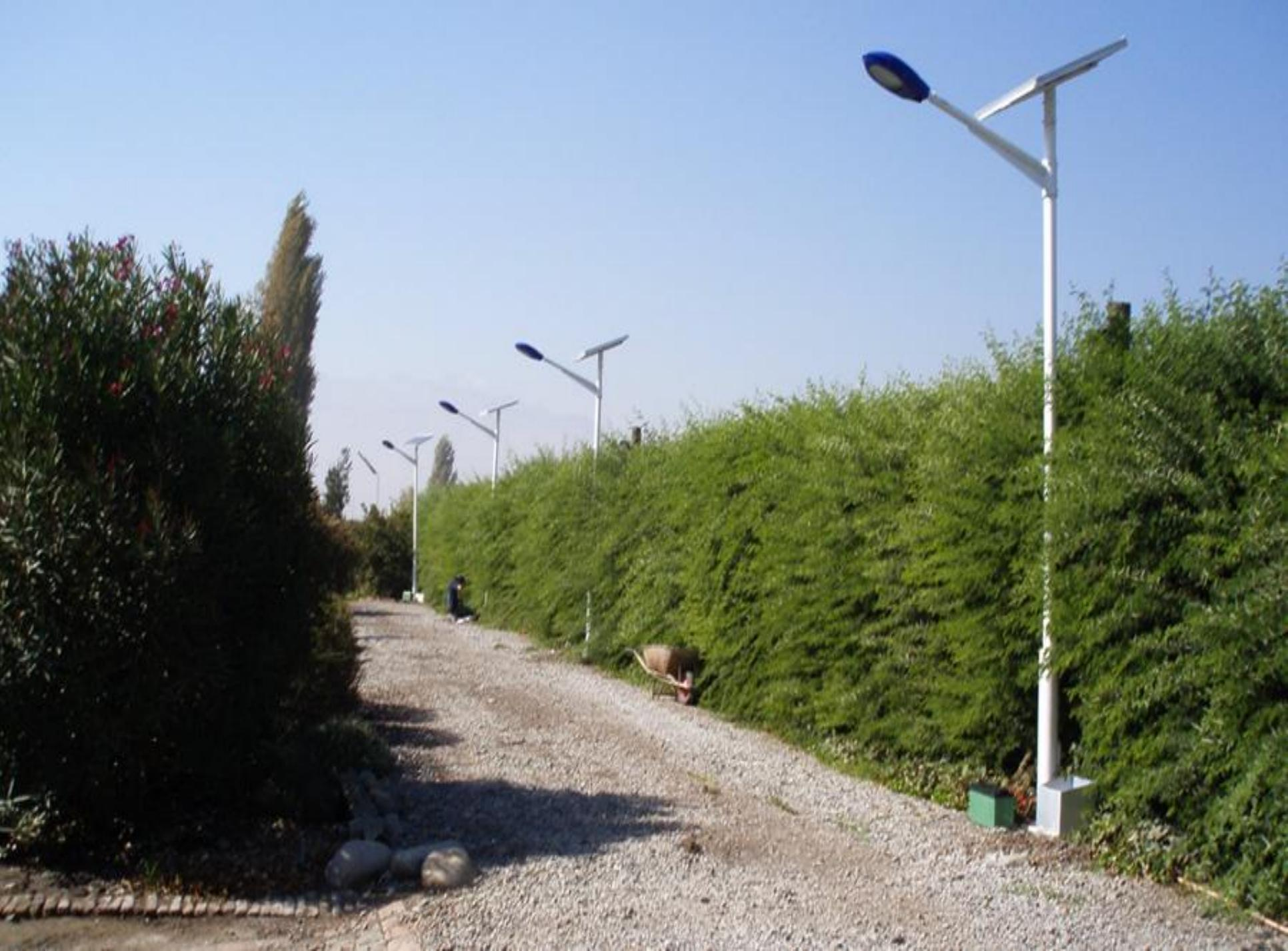
Luminaria Solar con Lámpara de Led de 70 Watts y sistema inteligente para administración de energía con un periodo de encendido de 10-12 hrs/día (toda la noche).
